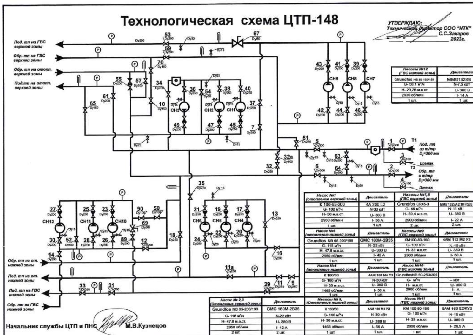
Рисунок 1.10 – Схема ЦТП-148 (ЗСТЭЦ)
